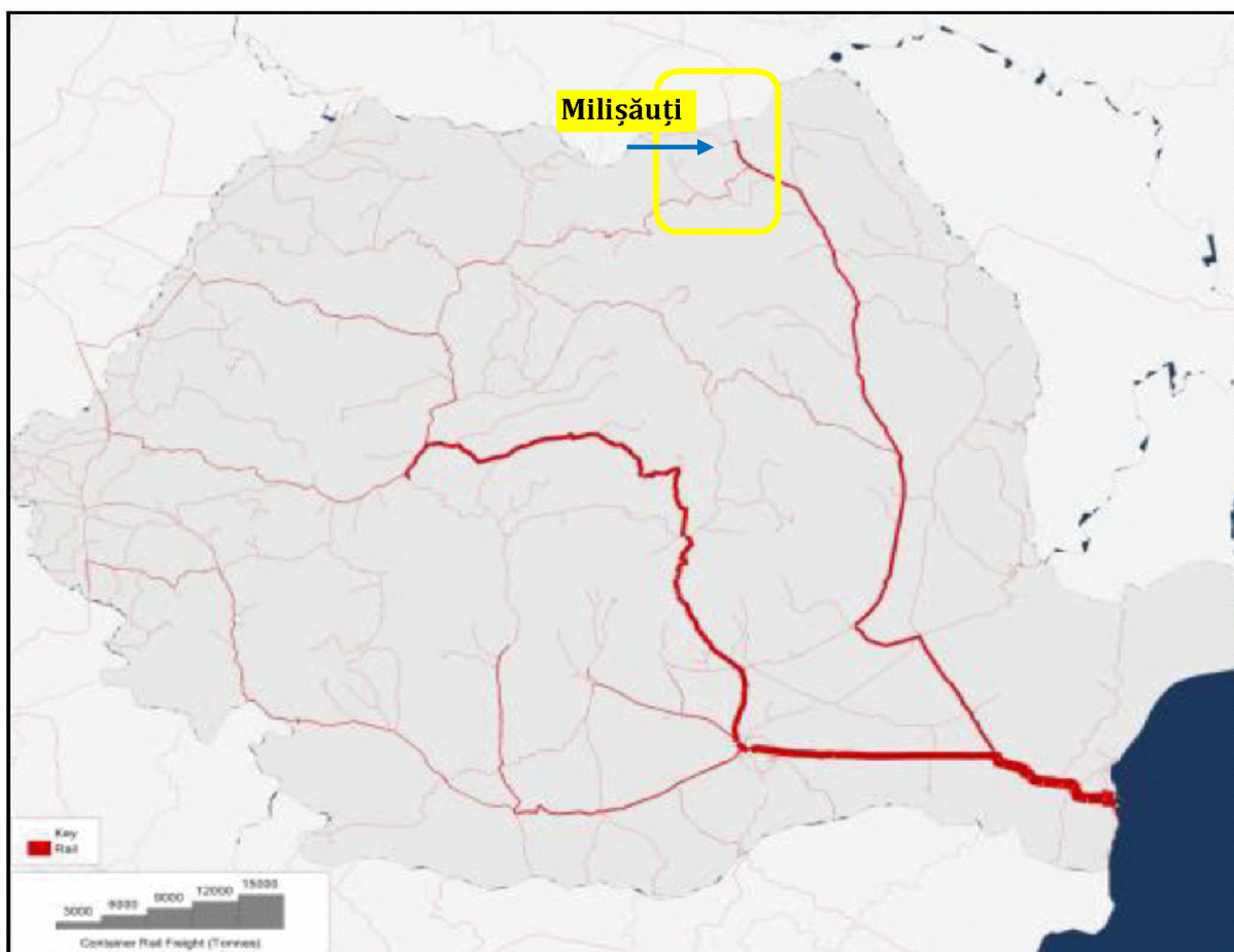
Figura 2.51. Fluxul de transport feroviar de containere, tone.
